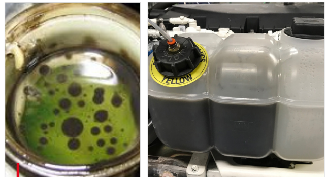
Restschmutz landet im Öl- und Kühlmittelbehälter
